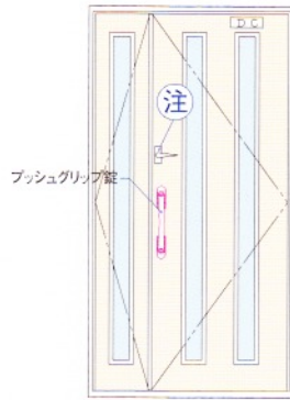
■ 親子開き防音ドア (両面F、小窓タイプ) 子扉 (両面F、小窓タイプ)
